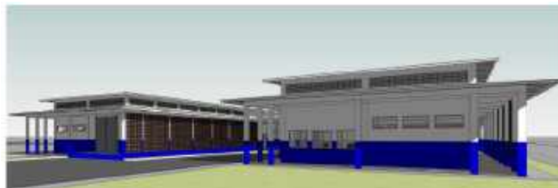
Figura 3 - Vista da Fachada Norte do Pavilhão. Nota-se o uso de cobogós em toda fachada oeste, permitindo ventilação, mas anulando insolação nessa fechada. (FAUSTINO, 2018 apud RACHID, 2018).
