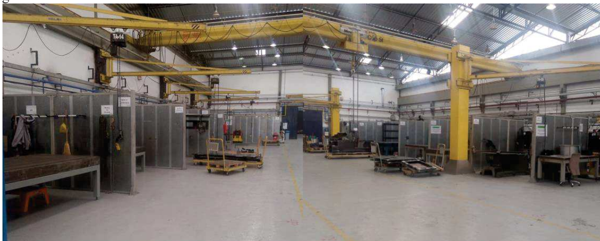
Figura 2 – Distribuição dos boxes de trabalho com atividades de soldagem e caldeiraria na fábrica.
