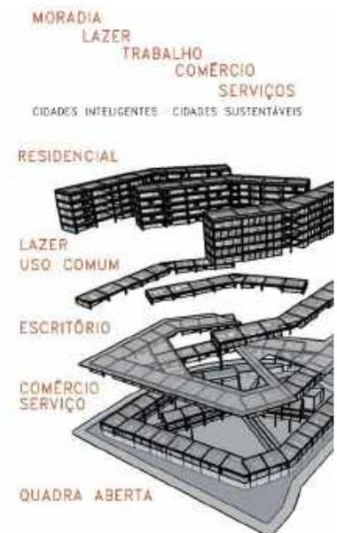
Figura 2 - Esquema sobreposto do edifício híbrido e suas camadas, para entendimento do seu funcionamento. Fonte: Elaborado pela autora.
