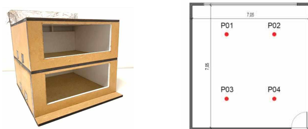
A) Maquete física em escala reduzida (1:25) representativa das sala de aula.
