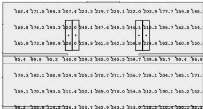
Figura 7: Planta com iluminâncias pelo software AGI-32
