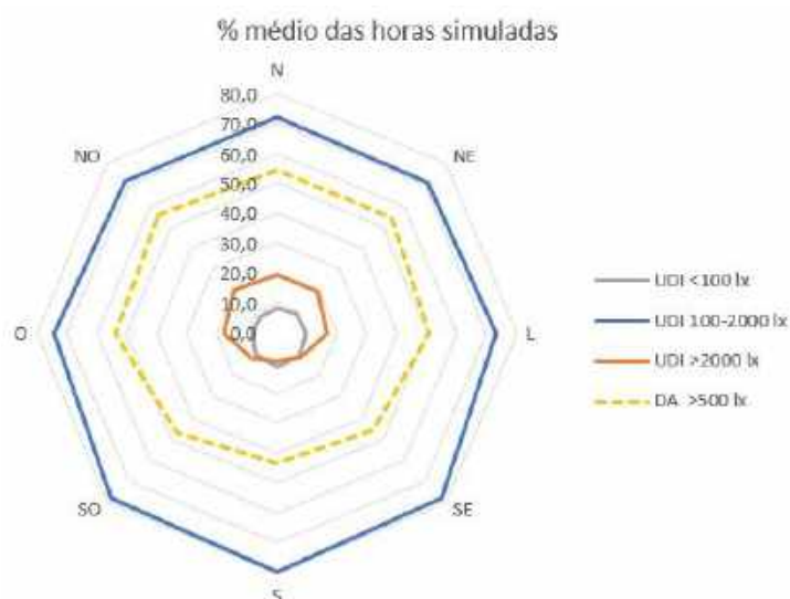
Figura 8: Gráfico de análise de UDI e DA das médias de todos os modelos simulados com relação à orientação das fachadas.
