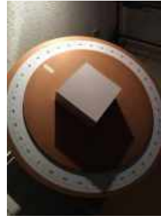
Figura 4 – Modelo físico reduzido ensaiado no heliodon
