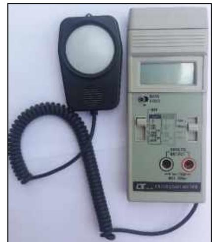
Figura 7 – Luxímetro usado para as medições de iluminância. Fonte: Acervo pessoal.
