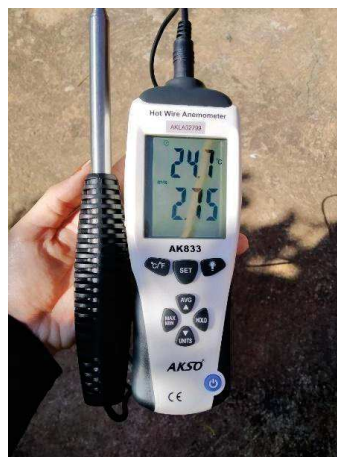
Figura 4 – Anemômetro para registro de temperatura e umidade.
