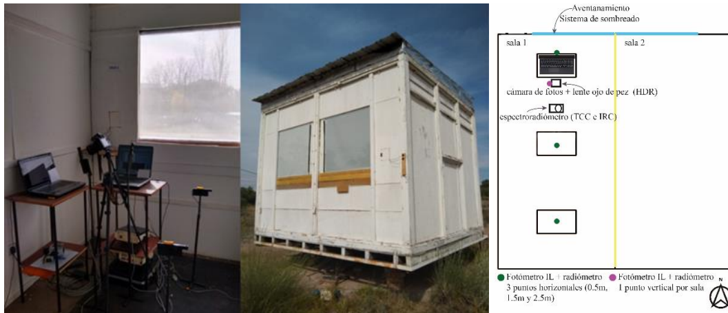
Figura 1 – Interior y exterior del box de ensayos experimentales. Figura 2 - Disposición de equipamiento en el interior del box (Laboratorio de ensayos experimentales).
