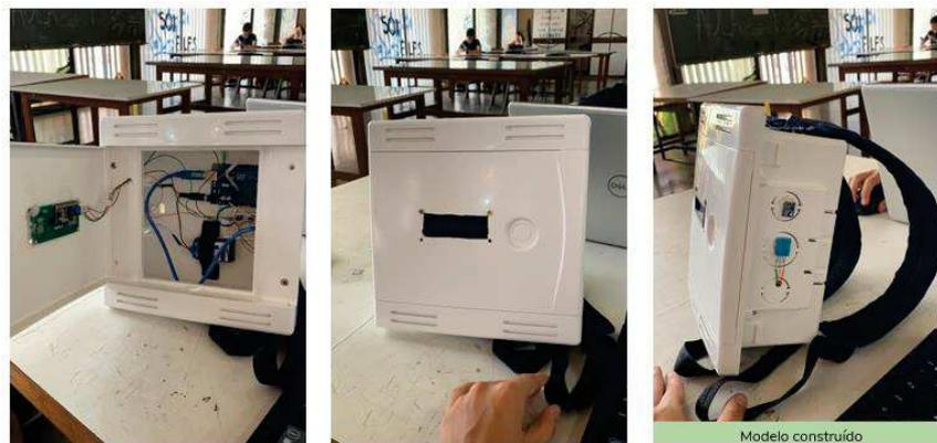
Figura 2 – Primeiro protótipo construído com quadro de distribuição.
