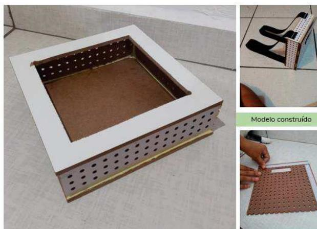
Figura 3 – Modelo de abrigo construído com MDF.
