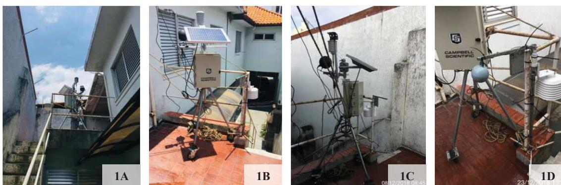
Figuras 1A, 1B, 1C e 1D (da esquerda para a direita) – Subponto inferior (A) com o corpo da Estação Científica *Campbell* (C), incluindo painel solar fotovoltaico (B), e um *Hobo* (D) (NOVAES, 2020)
