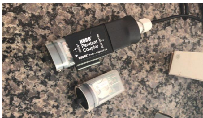
Figura 1 - Estação base USB óptica HOBO e Pendant Couple (AUTOR, 2019).
