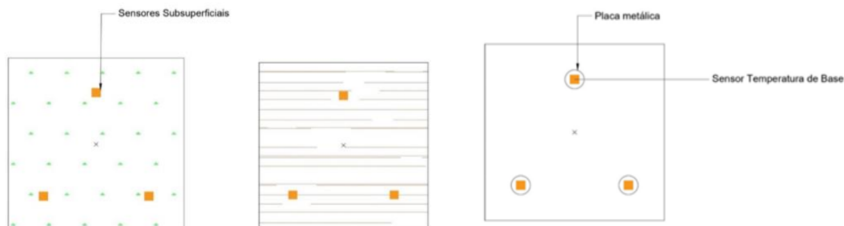
Figura 6 - Vista superior da disposição dos sensores nas camadas subsuperficial e de base. Fonte: Autoral, 2023.
