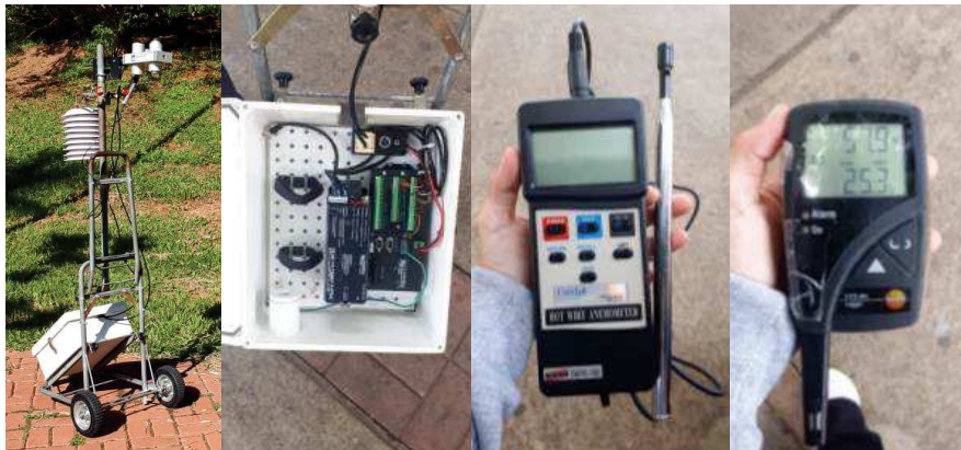
Figura 12: Instrumentos utilizados nos levantamentos microclimáticos: estação meteorológica móvel, aquisidor de dados, anemômetro e datalogger para registros de temperatura e umidade, respectivamente. Fonte: Autora, 2020.
