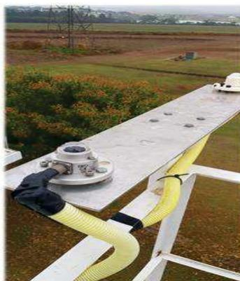
Figura 2 – Instrumento com os dois piranômetros instalados
