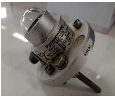
Figura 1 – Piranômetro MS-602 da fabricante EKO.
