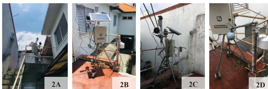
Figuras 2A, 2B, 2C e 2D (da esquerda para a direita) – Subponto inferior (A) com o corpo da Estação Científica Campbell (B e C), incluindo painel solar fotovoltaico (B), e um Hobo (D) (NOVAES, 2020)
