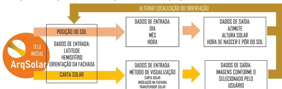
Figura 2 – Fluxograma de funcionamento da ferramenta ArqSolar
