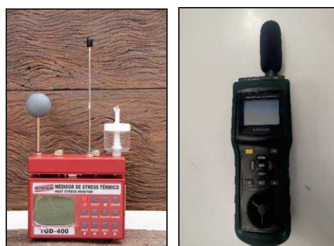
Figura 04 - À esquerda, medidor de estresse térmico com o globo cinza e à direita, multifuncional. (Autora, 2021).
