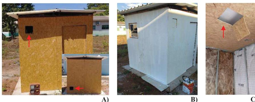
Figura 3 – Técnicas implementadas: (A) Ventilação natural cruzada; (B) Pintura com tinta refletante nas paredes e cobertura; (C) Ventilação natural chaminé.
