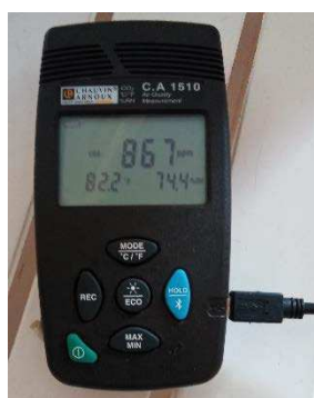
Figura 5- Equipamentos utilizados: (A) Sensor / Data-logger (concentração de CO 2 , temperatura e umidade relativa); (B) Extintor de CO 2 ; (C) Ventilador de teto.
