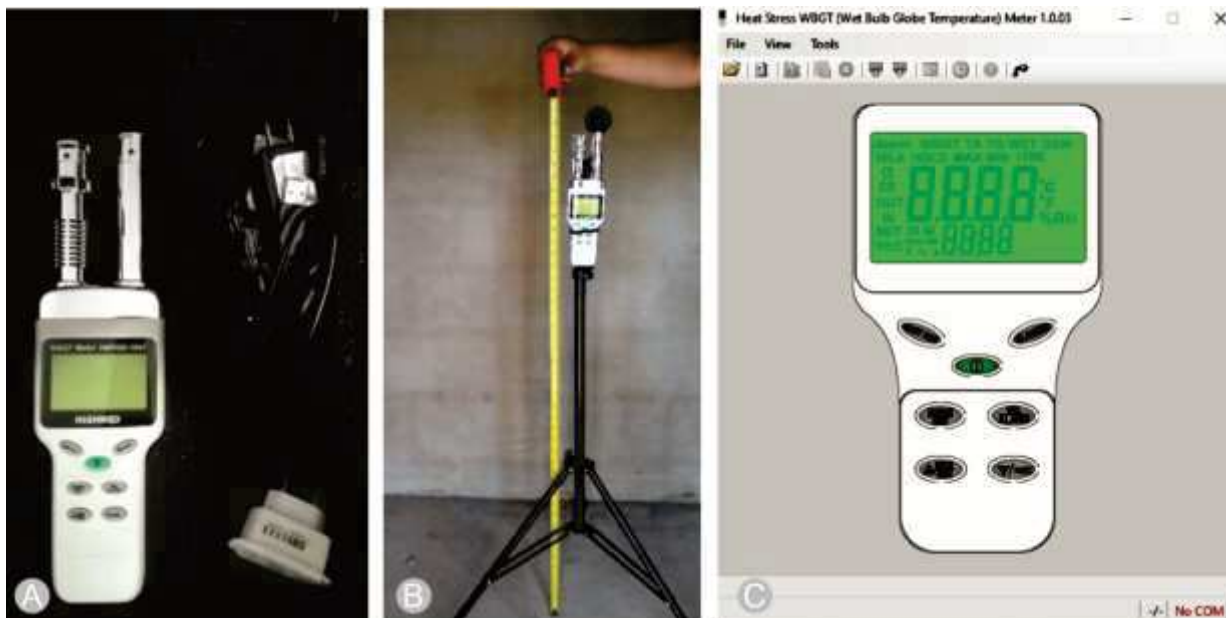
Figura 3 – Termômetro de globo, instalação no protótipo e interface de armazenamento de dados (Autores, 2021).
