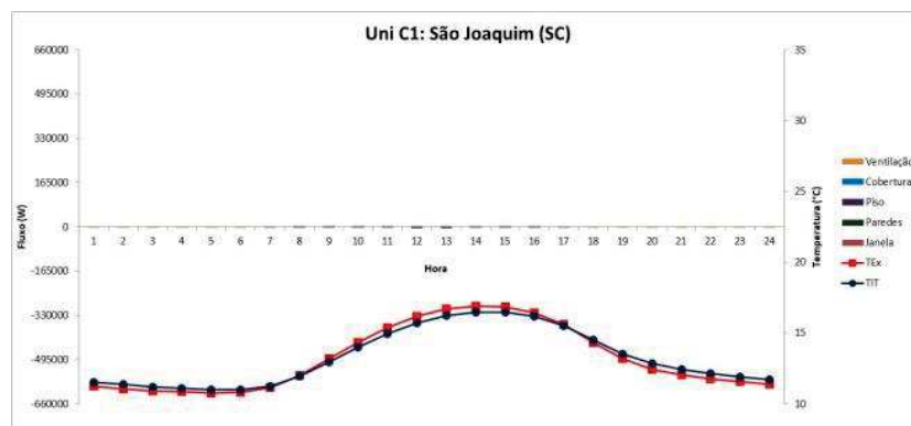
Figura 4- Dia Médio: Temperatura e Fluxo Térmico na torre da cidade de São Joaquim no caso 1
