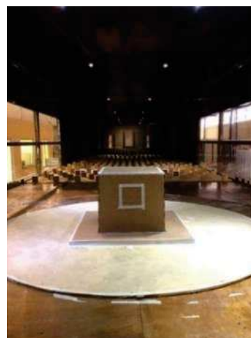
Figura 4 – (A) Perfil de velocidades da CLA utilizada nos ensaios; (B) elementos de rugosidade para auxiliar a formação do perfil de CLA (IPT, 2018 e A AUTORA, 2018).
