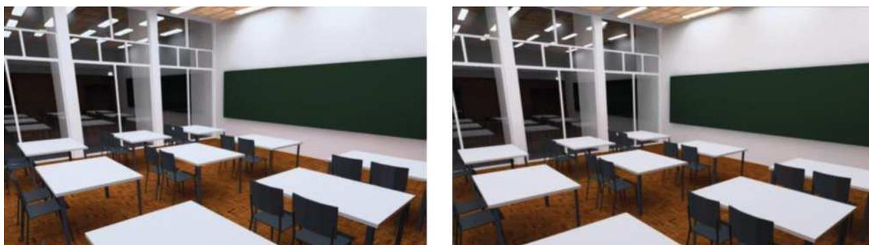
Figura 6a e 6b – Comparação visual gerada via simulação entre o sistema Fluorescente (imagem à esquerda) e o sistema LED (imagem à direita) na sala de aula.
