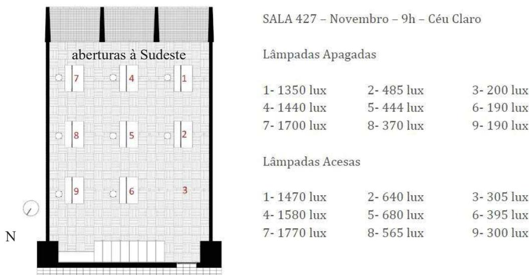
Figura 4 – Medições in loco realizadas na sala 427 do Edifício JMM (Adaptado de MORGADO, 1995).
