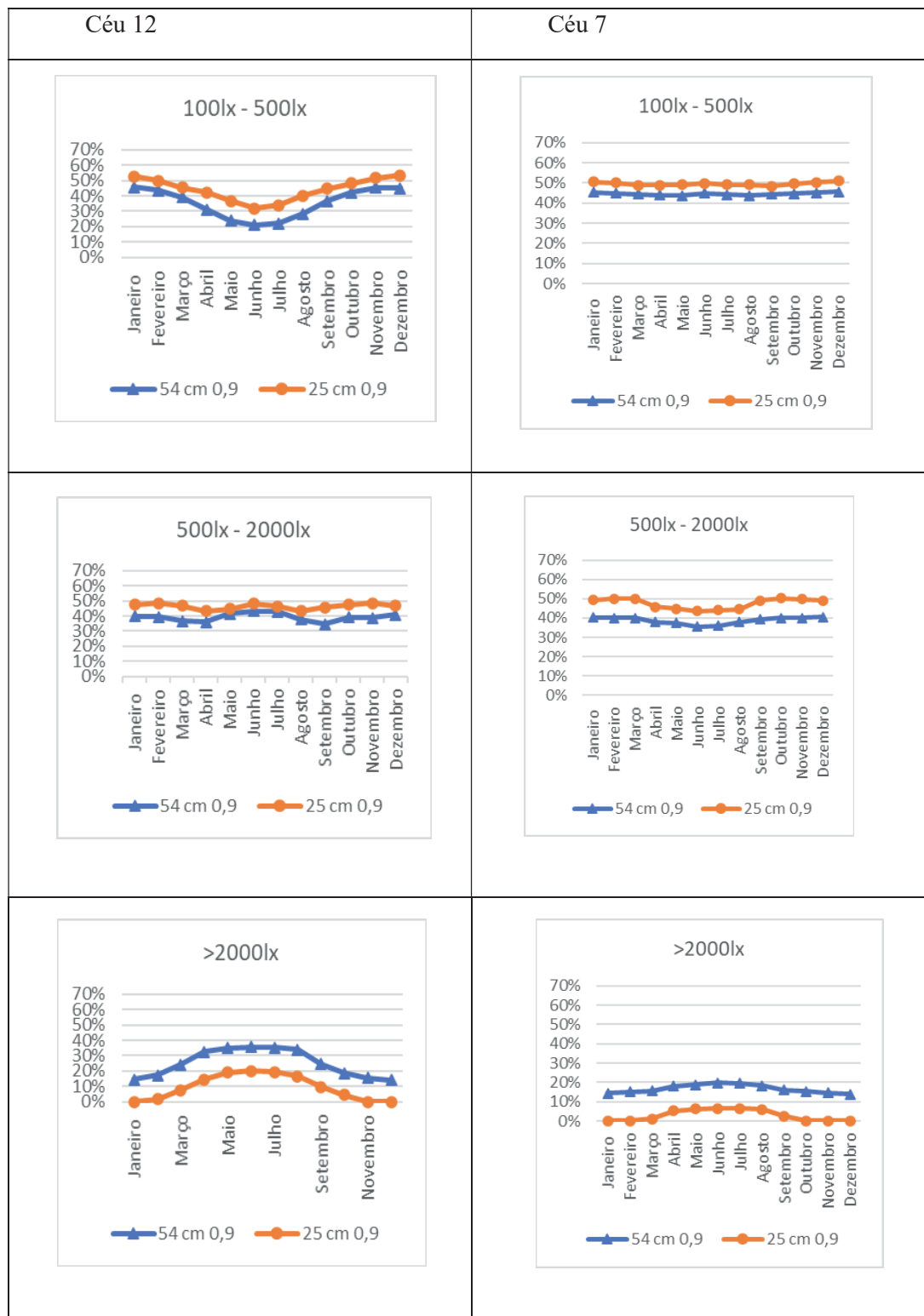
Figura 10 - Percentuais das UDI apresentados ao longo dos meses para os Céus 12 (claro) e 7 (parcialmente nublado), orientação Norte de acordo com Brise de 54 cm e de 25 cm, com coeficiente de refletância 0,9.
