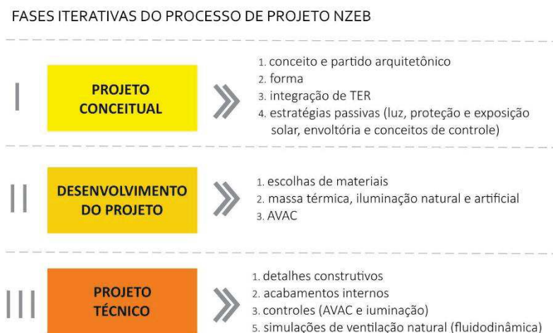
Figura 1 - Fases iterativas do processo de projeto NZEB. Fonte: adaptado de Athienitis; O'Brien, 2015
