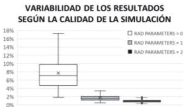
Figura 2: Variabilidad de los resultados de iluminancia según los parámetros de Radiance empleados en la simulación. Este rango de variabilidad determina el umbral a partir del cual no es posible saber si la variación en un resultado depende de alguna modificación en las características del modelo simulado o de la variabilidad intrínseca asociada al proceso estocástico de la simulación.
