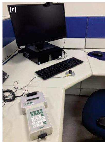
Figura 1 - Edifícios 1[a] e 2 [b], objetos na pesquisa em campo, e localização do sensor sobre plano de trabalho e *datalogger* LI-COR na estação individual de trabalho no edifício 1 [c]. Fonte: Acervo das autoras.
