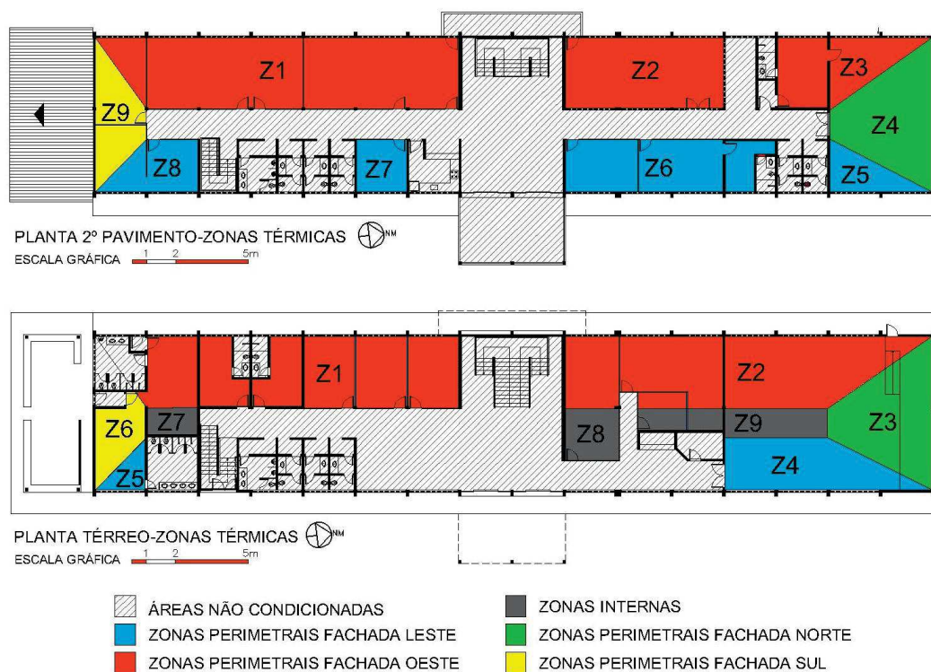
Figura 4 - Divisão das zonas térmicas, segundo a INI-C.
