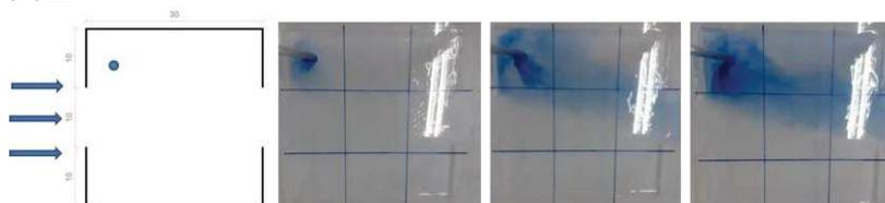
Figura 10 - Evolução do ensaio com corante azul em aberturas de 10 cm cada lado
