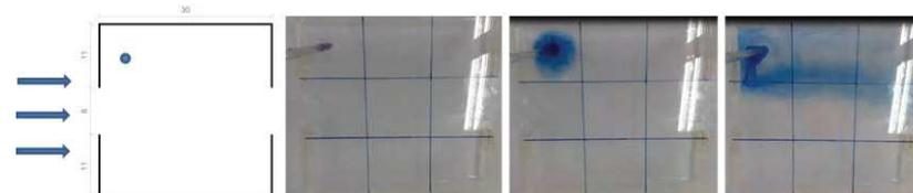
Figura 11 - Evolução do ensaio com corante azul em aberturas de 8 cm cada lado
