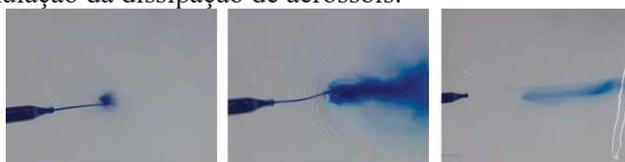
Figura 9 - Evolução do ensaio com corante azul diluído no fluido de ensaio.
