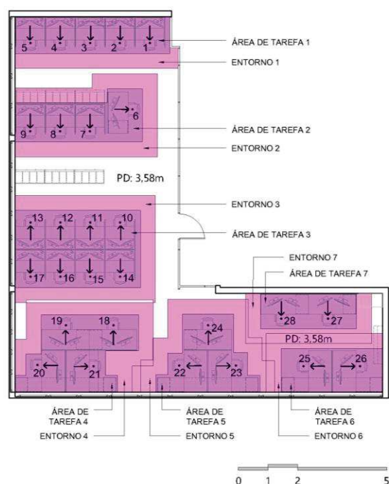
Figura 4 – Posição de cada ponto de cálculo (1 a 28) com indicação da direção do ângulo considerado para iluminação vertical e representação das superfícies de cálculo correspondentes a cada uma das sete áreas de tarefa e seus entornos imediatos.
