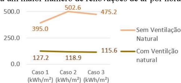
Figura 5 – Cargas ideais para condicionamento térmico.
