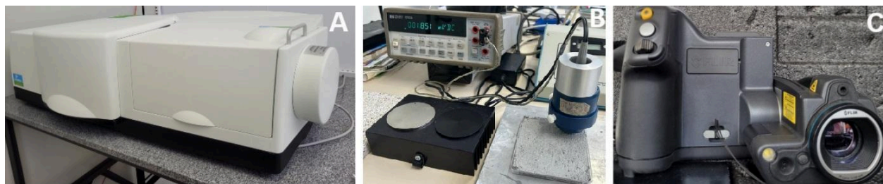
Figura 2: A) Espectrofotômetro LAMBDA 1050; B) Emissômetro AE1 D&S; C) Câmera Infravermelha FLIR T450SC.
