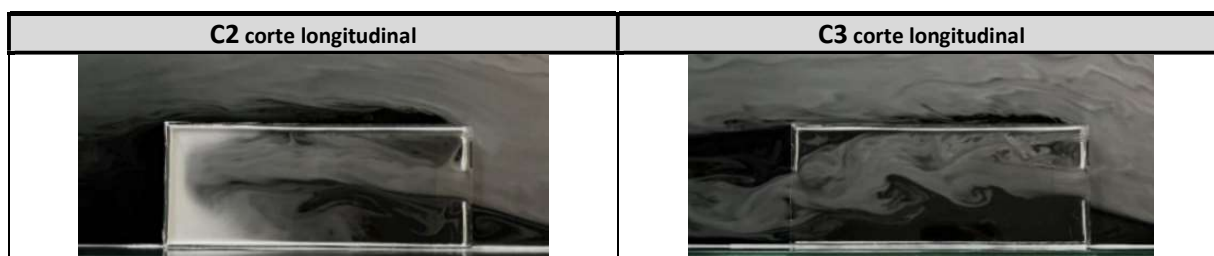
Quadro 4: Visualizações do fluxo de ar nos modelos C2 e C3 ensaiados na mesa d'água.
