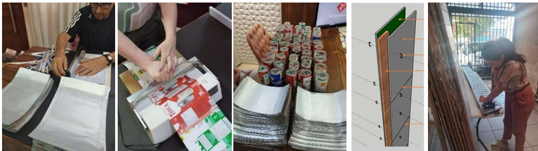
Figura 4: Preparação das tiras para fabricação do protótipo de painel
