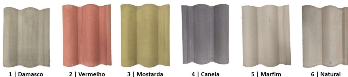
Figura 1: Telhas de concreto selecionadas. 1-5: pigmentadas. 6: convencional.
