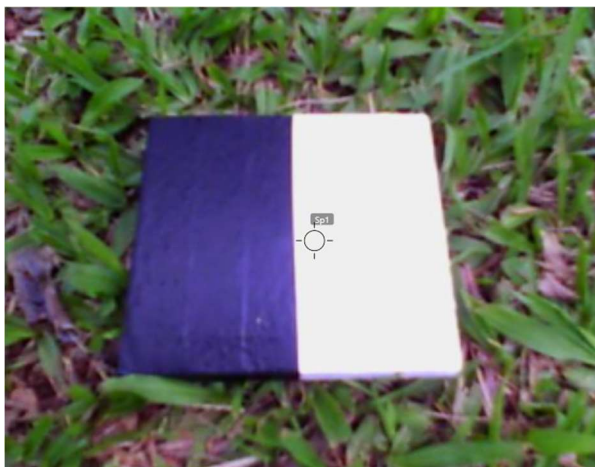
Figura 2: Medição da temperatura da amostra da manta líquida ML-01 utilizando um termógrafo
