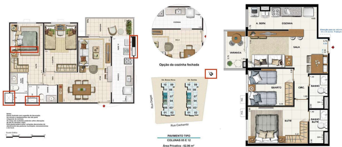
Figura 3: Indicação dos possíveis erros de leitura (a) e exemplo da planta baixa na vertical (b).
