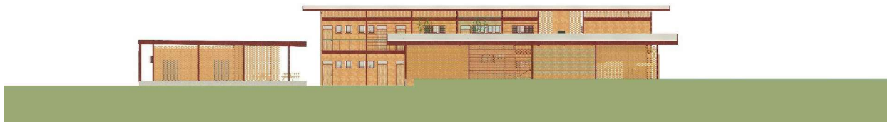
Figura 4b: Fachada Oeste e seus dispositivos de sombreamento: brises metálicos e cobogós.
