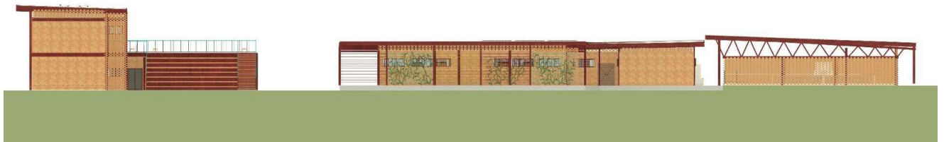
Figura 4a: Fachada Norte e seus dispositivos de sombreamento: brise metálico e cobogó
