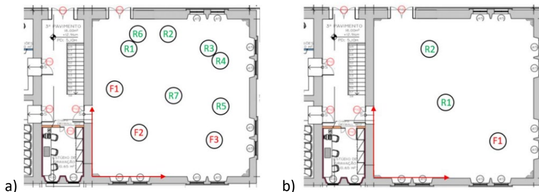
Figura 1: Planta baixa da sala de ensaios e pontos de medição, janelas fechadas (a) e abertas (b).
