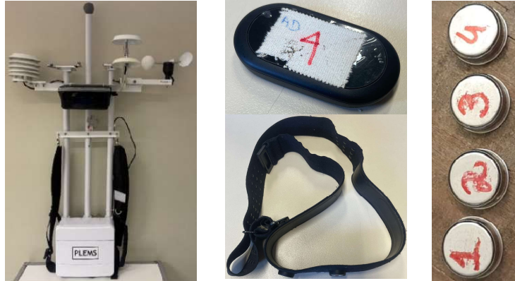
Figura 1: a) Equipamento PLEMS (esquerda), b) Dispositivo Polar H10 (centro) e c) I-buttons (direita).
