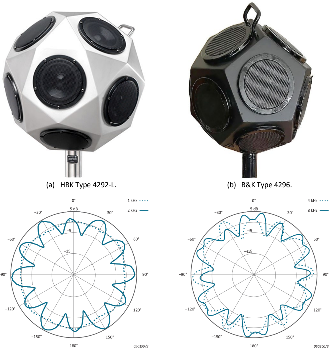
(c) Direcionalidade do icosidodecaedro HBK Type 4292-L (Figura 2 (a)).
