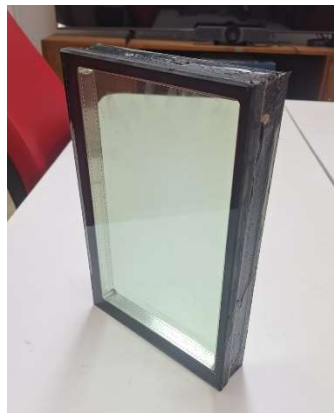
Figura 7: Amostra de vidro insulado enviado para este estudo
