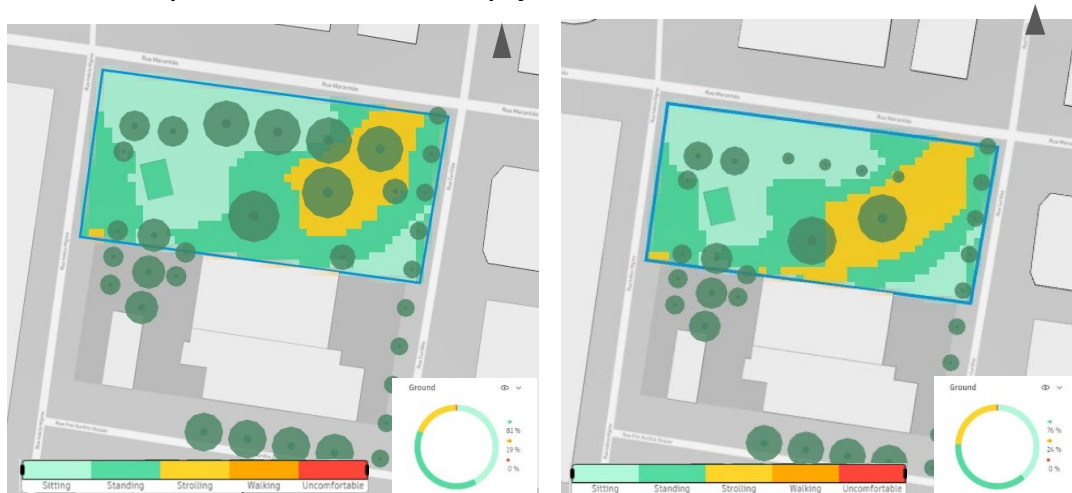
Figura 8 – Simulação do vento. À esquerda, cenário pré-reforma com 81% dos espaços confortáveis. À direita, cenário pós-reforma com 76% dos espaços confortáveis conforme escala de Lawson LDDC .
