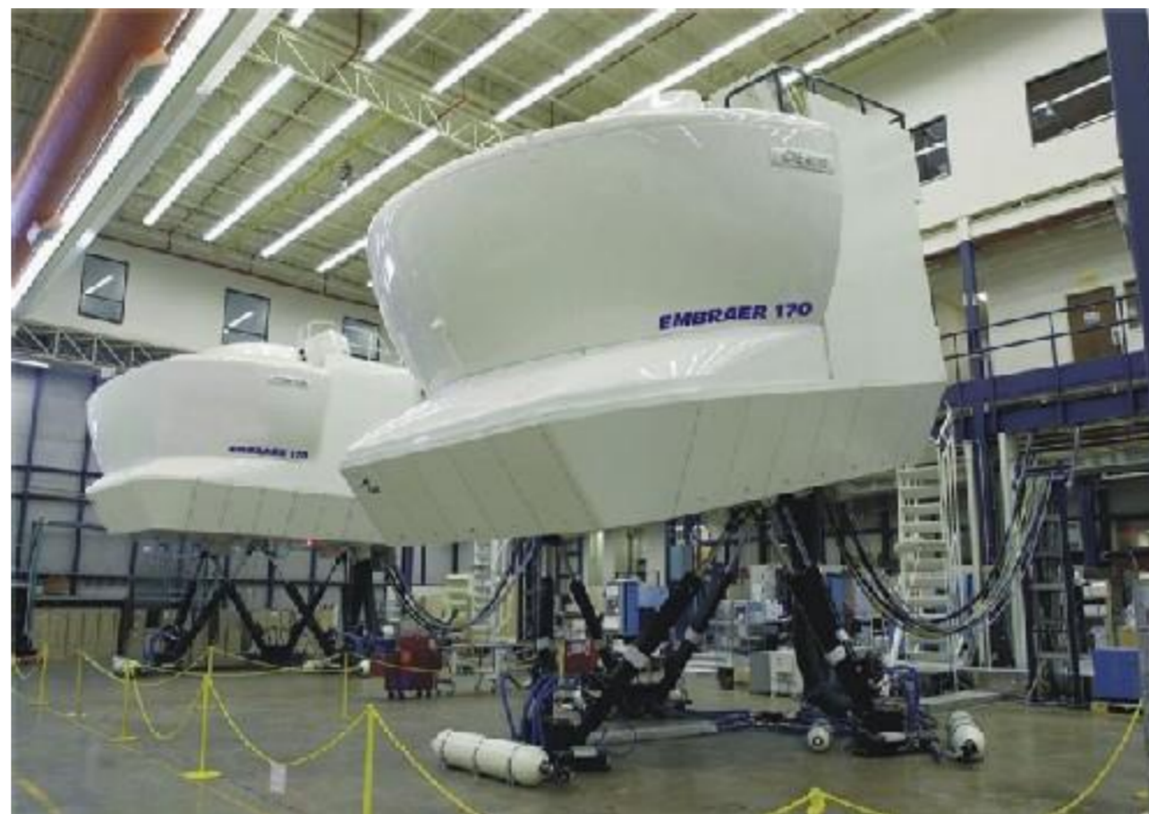
Figura 2: Simulador de voo do Embraer 170, realidade virtual no treinamento de pilotos.
