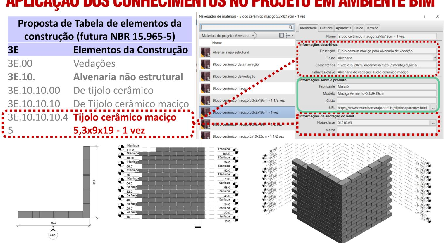
Figura 2: Sistematização das Informações. Codificação. Inserção das Informações em Ferramenta BIM. Projeto de Alvenaria de vedação em Revit.
