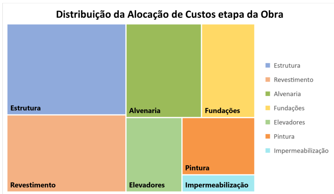
Figura 2 - Custos aproximados das etapas de uma obra
