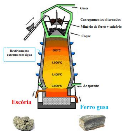
Figura 1 – Representação do Alto-Forno
