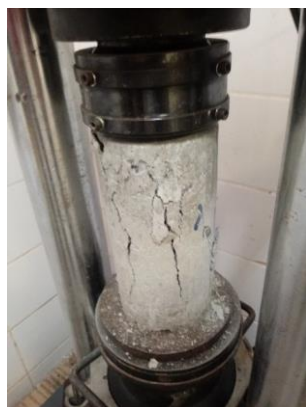
Figura 4 – Ruptura padrão dos CPs moldados utilizando o soquete
